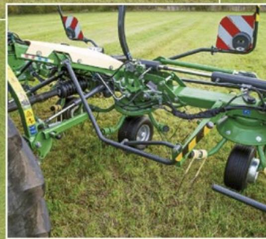
men des Wenders. Dieses Trapez verhindert sicher das Wedeln der Maschine während der Arbeit. Sie können die Maschine auch bei kompletter Schrägstellung ohne schlechtes Gewissen mit dem Hubwerk ausheben. Super sanft, ohne einen Ruck schwenkt der Vendo in die Mittelstellung. Auch auf der Straße stabilisieren diese Streben die Maschine hinter dem Schlepper. Dass die Unterlenkerstreben des Schleppers für eine sichere Fahrt verriegelt sein müs-
