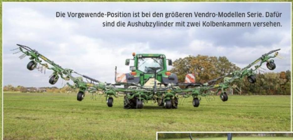
Die Vorgewende-Position ist bei den größeren Vendo-Modellen Serie. Dafür sind die Aushubzylinder mit zwei Kolbenkammern versehen.
