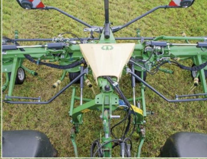
Die beiden Zylinder stabilisieren den Dreipunktbock hervorragend. Links und rechts die Kinematik für den Schutz, der sich beim Ausklappen absenkt und den Schlepperreifen Platz schafft.
