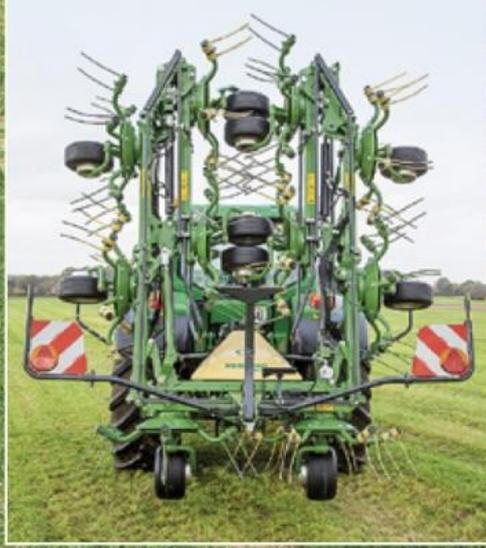
Kinematik-Kür: Fast 11 m Arbeitsbreite falten sich in weniger als einer halben Minute auf 3 m zusammen. Mit hohem Schwerpunkt allerdings.
